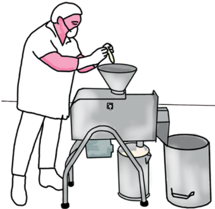
Figura 8. Despulpamento das frutas por meio de um despulpador horizontal simples.
